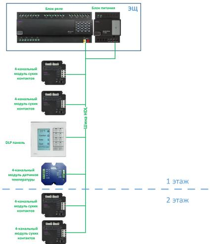
Предлагается использовать оборудование марки **HDL Bus-pro**. Данная система УД может быть расширена за счет присоединения к шине других интеллектуальных устройств указанного производителя с целью увеличения функциональных возможностей.
